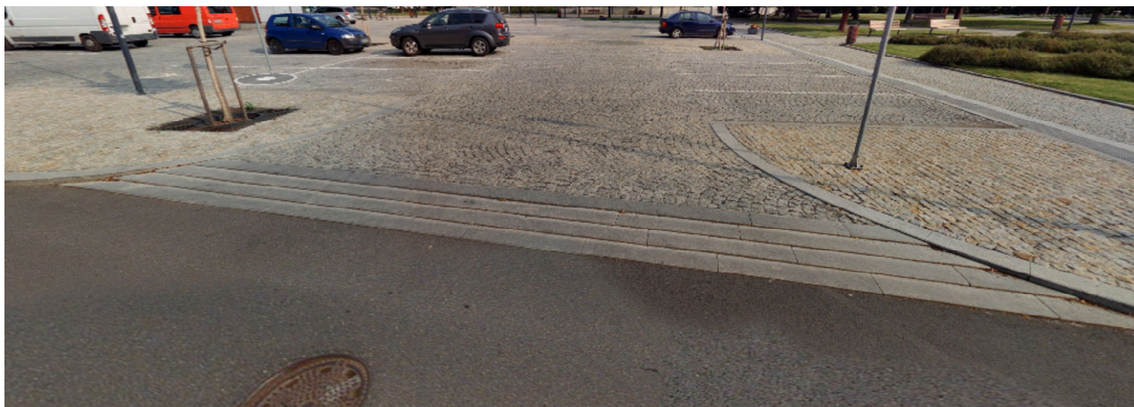
Přejezdové prahy – žulové výškově odstupňované obrubníky – takto budou řešeny vjezdu na komunikaci po obvodu náměstí z ulice Národní a ulice Legií
